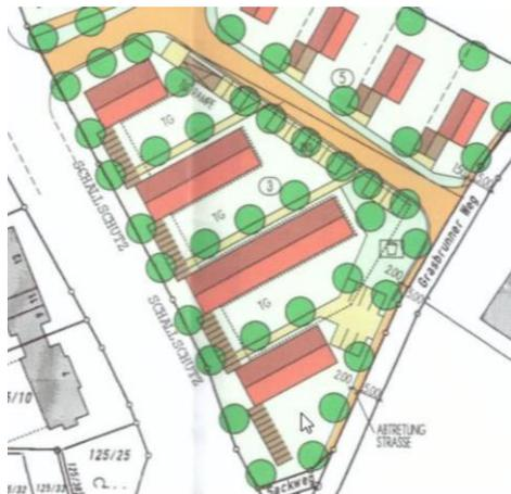
In Variante 1 werden die Baukörper giebelständig angeordnet und eine Straßenanbindung an die Putzbrunner Straße geschaffen. Zwischen den giebelständigen Gebäuden sind in dieser Variante Lärmschutzwände vorgesehen, um die Lärmwerte im WA einzuhalten. Die Stellplätze werden in einer Tiefgarage untergebracht, die von der neuen Erschließungsstraße aus erschlossen wird.
